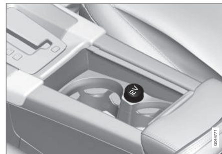
Preso da 12 V nel tunnel, sedile anteriore.
