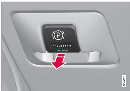
Comando del freno di stazionamento - distacco.
