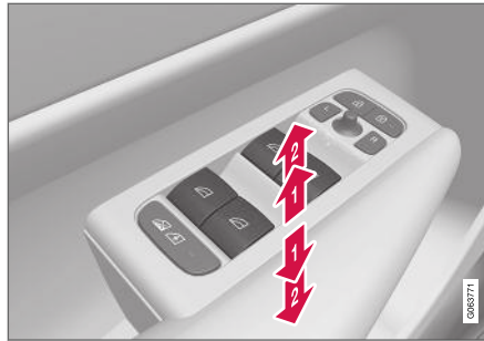
Керування вікнами з електропідійомниками.
