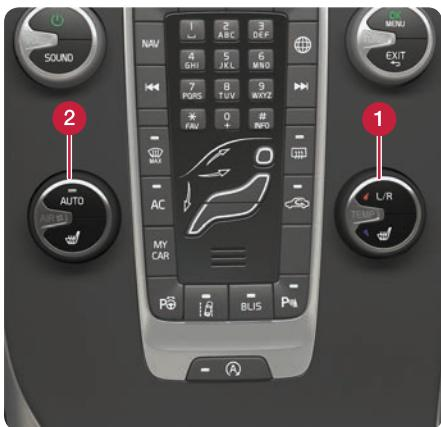
**1** Pressione para temperatura individual. Pressione várias vezes para seleccionar as definições para o lado esquerdo, direito ou para ambos os lados. Rode para ajustar a temperatura. O ecrã da consola central exibe a temperatura seleccionada para cada lado.
