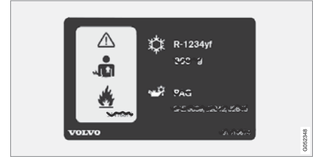
2 ماصق نظام مكيف الهواء في السيارات المزودة بوسائل التبريد R1234yf.
