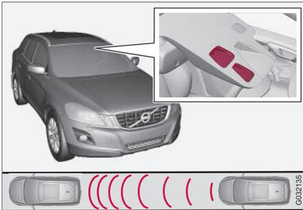
Ventanas del emisor y el receptor del sensor láser<sup>15</sup>.
