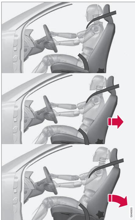
El sistema WHIPS se activa durante una colisión por alcance en función del ángulo de incidencia,
