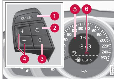
Teclado de volante y pantalla en vehículo **sin** limitador de velocidad<sup>7</sup>.
