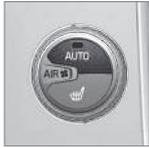
La función Auto regula de forma automática la temperatura (p. 141), el aire acondicionado (p. 142), la velocidad del ventilador (p. 140), la recirculación (p. 143) y la distribución de aire (p. 135).
