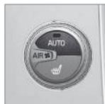
Gire la perilla para aumentar o reducir la velocidad del ventilador, **AUTO** se desconectará. Si se selecciona **AUTO**, la velocidad del ventilador se regulará de forma automática (p. 141). Se desconecta la velocidad de ventilador ajustada con anterioridad.
