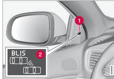
Colocación de la lámpara BLIS<sup>25</sup>.
