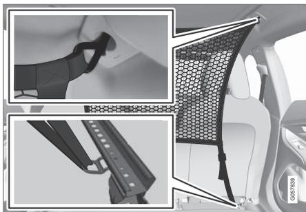
1. Fije uno los ganchos en la fijación del techo con los cierres de la cinta vueltos hacia usted.
