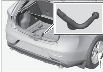
El enganche para remolque desmontable se guarda en el taco de gomaespuma<sup>15</sup> debajo del suelo del maletero cuando no se utiliza.
