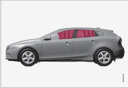
El airbag de techo lateral IC (Inflatable Curtain) forma parte del sistema SIPS (p. 38). El sistema IC está instalado en los dos lados del techo interior y protege tanto al conductor como a los pasajeros de los asientos laterales. En caso de una colisión de suficiente intensidad, los sensores reaccionan y el airbag de techo lateral se infla.
