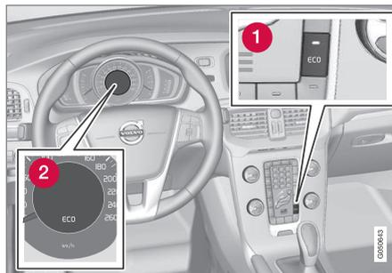
**1** Conexión y desconexión de ECO
