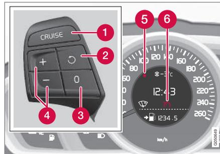
Teclado de volante y pantalla en vehículo **sin** limitador de velocidad<sup>6</sup>.
