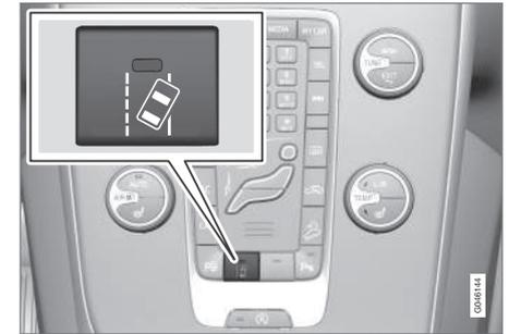
Pulse el botón de la consola central para conectar o desconectar la función. La luz del botón se enciende cuando la función está conectada.
