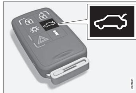
Con el botón
