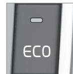
Si está activada la función ECO, el motor puede apagarse automáticamente antes de detenerse el vehículo.
