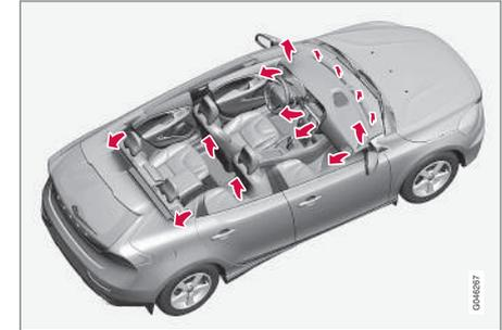
En la posición **AUTO\***, la distribución del aire es completamente automática.
