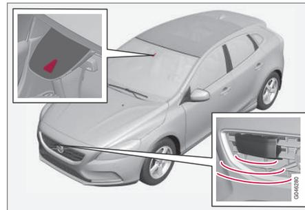
Sensor de cámara y de radar<sup>23</sup>.
