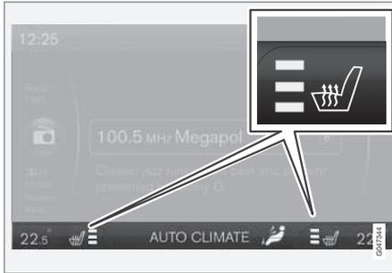
El nivel de calefacción se indica en la pantalla de la consola central.
