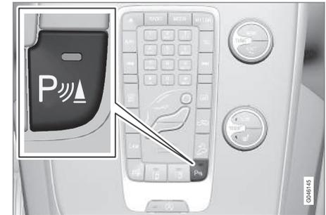
Conexión y desconexión de los sensores de aparcamiento asistido y CTA<sup>32</sup>.
