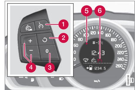
Teclado de volante y pantalla en vehículo **con** limitador de velocidad<sup>6</sup>.
