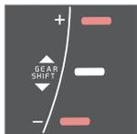
Indicador de cambio de marcha para caja de cambios manual. Sólo se ilumina al mismo tiempo un marcador - en conducción normal se enciende únicamente el situado en medio.
