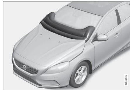
El airbag para peatones (Pedestrian Airbag) está instalado debajo del capó junto al parabrisas. En ciertas colisiones frontales con un peatón, los sensores en el parachoques delantero reaccionan y el airbag se despliega si se calcula que la fuerza del impacto es lo suficientemente grande. Los sensores están activos a velocidades de 20-50 km/h (12-30 mph) y a una temperatura ambiente entre -20 y +70 °C.
