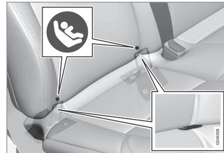
Los puntos de fijación del sistema ISOFIX están en la parte inferior del respaldo del asiento trasero, en las plazas laterales.
