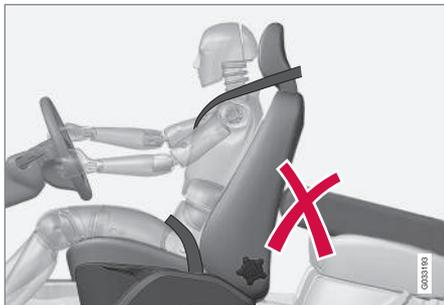
No coloque en el asiento trasero objetos que puedan impedir el debido funcionamiento del sistema WHIPS.
