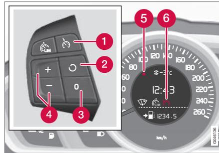
Teclado de volante y pantalla en vehículo **con** limitador de velocidad<sup>4</sup>.
