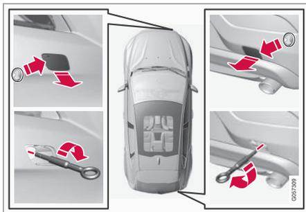
1. Saque la anilla de remolque que se guarda en el taco de gomaespuma debajo del suelo del maletero.
