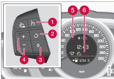
Teclado de volante y pantalla en vehículo **con** limitador de velocidad<sup>3</sup>.
