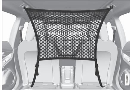
La red de carga se monta en cuatro puntos de fijación.
