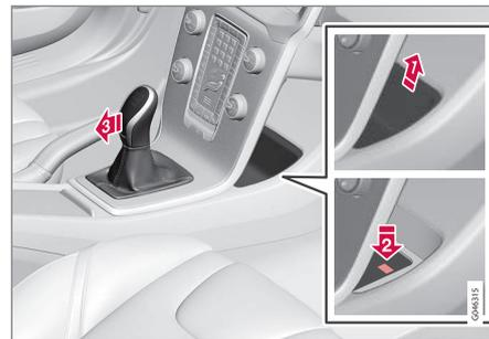
Si el automóvil no está en condiciones para conducirse, por ejemplo, si la batería de arranque está descargada, el selector de marcha debe sacarse de la posición **P** para poder mover el automóvil.
