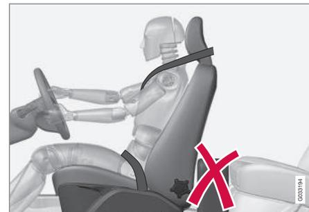
No coloque en el suelo detrás del asiento del conductor o del acompañante objetos que puedan impedir el debido funcionamiento del sistema WHIPS.
