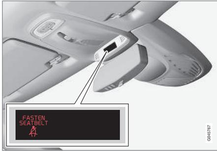
El aviso acústico depende de la velocidad y, en algunos casos, del tiempo. La señal luminosa se puede ver en la consola del techo y en el cuadro de instrumentos (p. 68).
