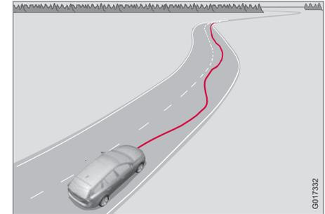
La cámara explora las señalizaciones laterales del carril y compara el recorrido de la carretera con los movimientos del volante. El conductor recibe un aviso cuando el vehículo no sigue el carril de manera regular.
