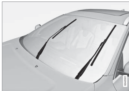
位於維修位置的雨刷片。
