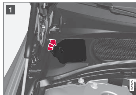
Розширювальний бачок охолоджувальної рідини.
