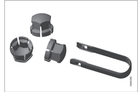
Інструмент для видалення пластикових ковпачків з колісних болтів.
