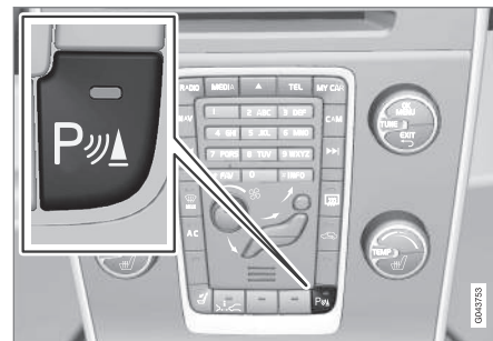
Kontrolka Zapnuto/Vypnuto parkovací asistence a funkce CTA*.
