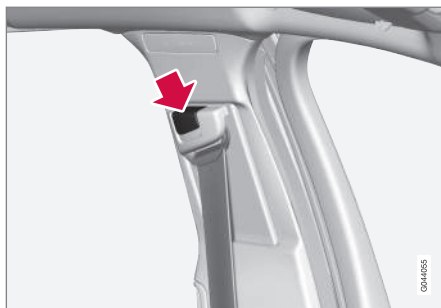
Nastavení výšky bezpečnostního pásu. Stiskněte tlačítko a přesuňte bezpečnostní pás ve svislém směru. Umístěte pás co nejvýše - nesmí však vést přes krk.
