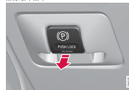
駐車煞車控制 - 釋放。
