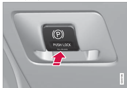
駐車煞車控制 - 使用。
