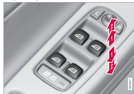
Regulering av vindusheiser.
