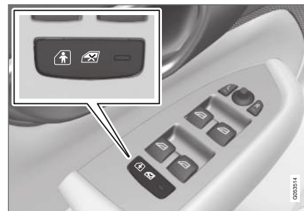
Botón de conexión y desconexión eléctrica.
