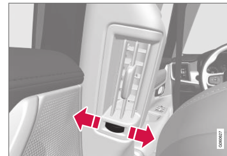
Rotella della bocchetta di ventilazione 2 .
