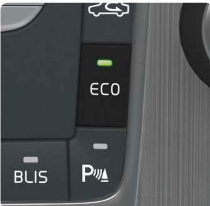
Ein Druck auf die Taste **ECO** aktiviert ein hinsichtlich des Kraftstoffverbrauchs optimal abgestimmtes Fahrprogramm mit u. a. folgenden Änderungen:
