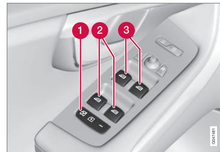
Панель управления в двери водителя.
