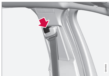
Regulacja wysokości pasa bezpieczeństwa. Naciśnąć przycisk i przesunąć pas w kierunku pionowym. Ustawić pas możliwie jak najwyżej, ale w taki sposób, by nie ocierał się o szyję.
