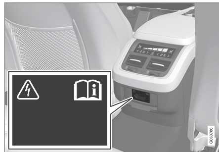
Stroomaansluiting in tunnelconsole, achterin.
