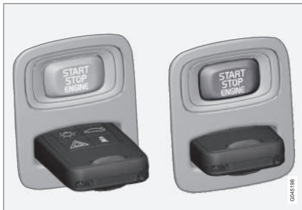
Contactsloot met transpondersleutel uitgetrokken/ingedruwd.
