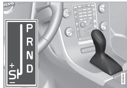
D: automatisch schakelen. +/-: handmatig schakelen. S 6 : Sport-stand*.
