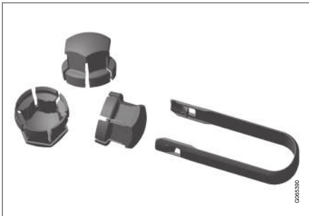
Nástroj pro sejmutí plastových krytek šroubů kol.
