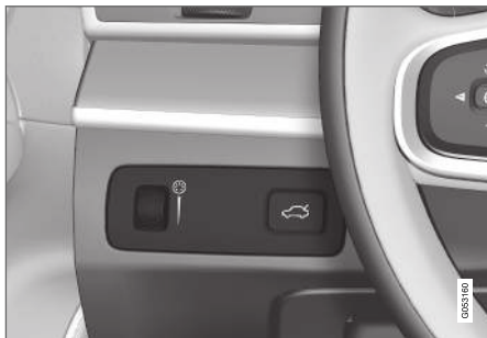
Kolečko (doleva) pro nastavení jasu interiéru.
