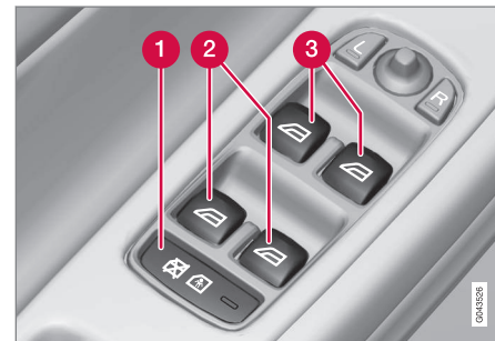
A vezetőajtó vezérlőpanelje.
