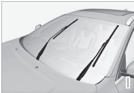
Az ablaktörlő lapátok a szervizállásban.
