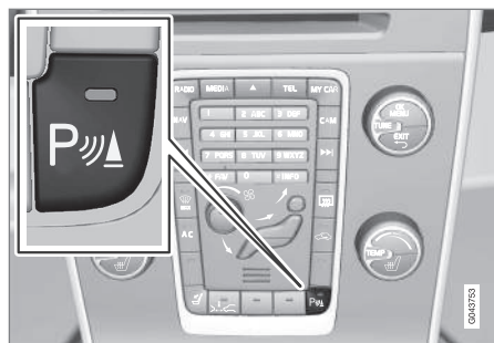
Conexión y desconexión de los sensores del aparcamiento asistido y el CTA.
