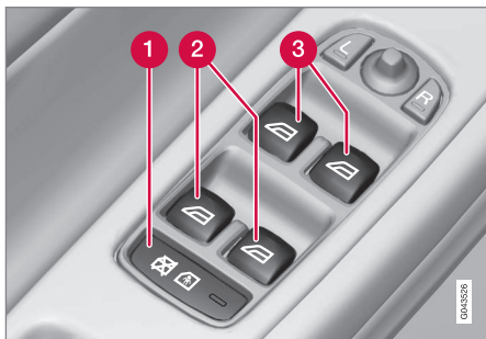
Painel de comando da porta do condutor.
