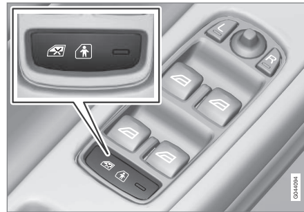
Painel de comando da porta do condutor.
