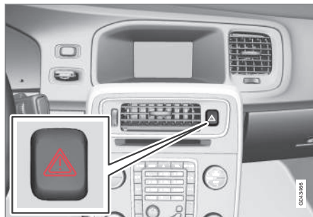
Botão dos piscas de emergência.
