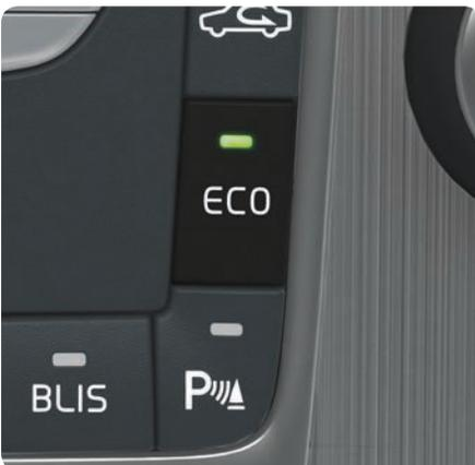
Une pression sur le bouton **ECO** active un programme de conduite optimal et économique en carburant impliquant les modifications suivantes :
