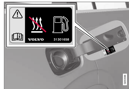
Πινακίδα στο εσωτερικό της θυρίδας ρεζερβουάρ καυσίμων.
