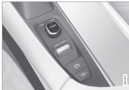
Ручка запуска в тоннельной консоли.
