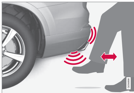
Взмах ноги в пределах зоны действия датчика.
