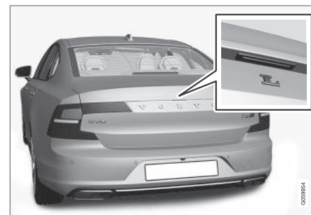
Обрезиненная нажимная пластина в крышке багажника используется только для отпирания.
