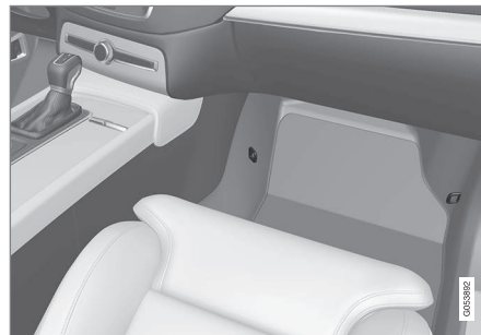
Расположение точек крепления для переднего сиденья.
