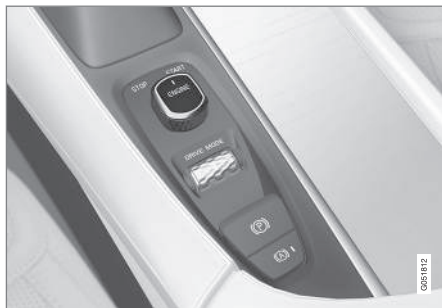
Ручка запуска в тоннельной консоли.
