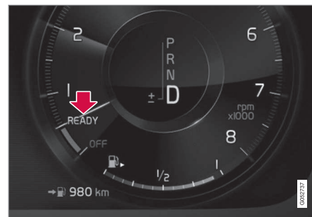
Функция в действии и двигатель в режиме автоматической остановки.
