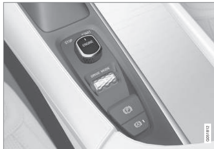
Ручка запуска в тоннельной консоли.
