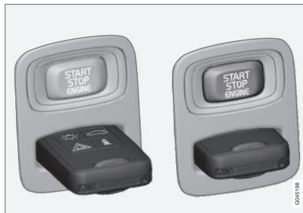
Contactslot met transpondersleutel uitgetrokken/ingeduwd.
