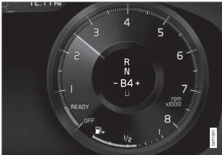
Juhiekraan käikude vahetamisel roolilabadega (manuaalse käiguvahetuse režiim).
