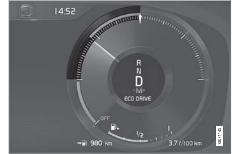
مقياس Eco في شاشة السائق قياس ١٢ بوصة*.
