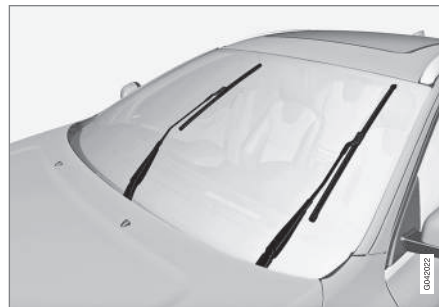
Escobillas de limpiaparabrisas en posición de servicio.
