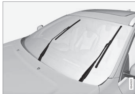
Pióra wycieraczek w pozycji serwisowej.
