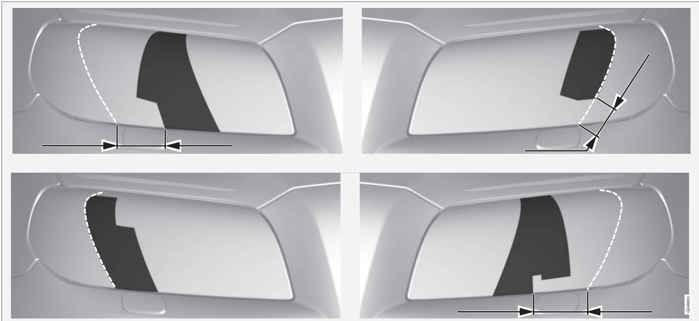
Górny rząd: w samochodzie z kierownicą po lewej stronie, szablony A i B. Dolny rząd: w samochodzie z kierownicą po prawej stronie, szablony C i D.
