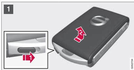
1 **1** ➔ Tenez la télécommande avec la face avant visible et le logo Volvo dans le bon sens. Poussez le bouton à droite sur le bord inférieur de l'anneau porte-clés. Poussez la coque de la face avant de quelques millimètres vers le haut.
