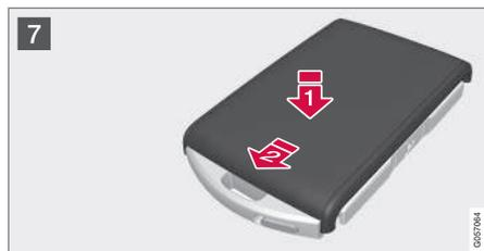
7 Remplacez la face arrière de la coque et l'enfoncer jusqu'à entendre un clic.
