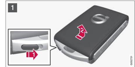
**1** ➔ Tenez la télécommande avec la face avant visible et le logo Volvo dans le bon sens. Poussez le bouton à droite sur le bord inférieur de l'anneau porte-clés. Poussez la coque de la face avant de quelques millimètres vers le haut.
