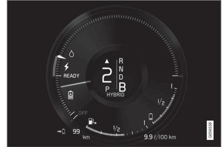
La voiture génère un courant et charge la batterie, lors par ex. d'une faible pression sur la pédale de frein ou lors d'un frein moteur en descente.
