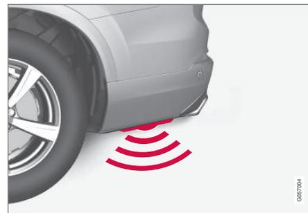
Si la voiture est équipée d'une tôle de protection/diffuseur\*, le capteur sera alors placé dans le coin gauche du pare-chocs.
