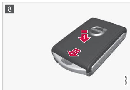
8 Retournez la télécommande et remplacez la coque avant en l'enfonçant jusqu'à entendre un clic.
