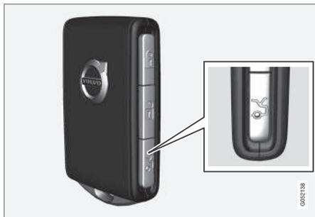
Grâce au bouton
