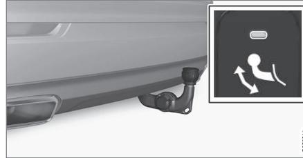
3. Poussez le crochet d'attelage en butée pour le fixer et le verrouiller. Le témoin reste allumé en orange.
