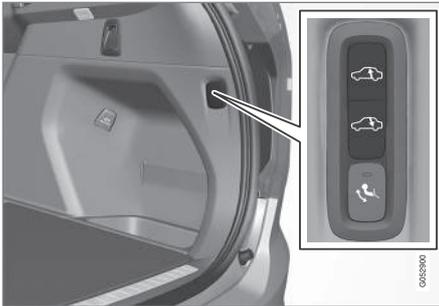
Utilisez les boutons dans le compartiment à bagages pour ajuster la hauteur de l'arrière de la voiture afin de faciliter le chargement/déchargement ou pour atteler une remorque. Référez-vous à la section "Chargement".
