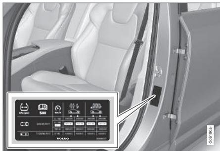
L'autocollant de pressions de pneu sur l'intérieur du montant de porte du côté conducteur (entre les portes avant et arrière) quelle pression les pneus doivent avoir à différentes conditions de charge et de vitesse.
