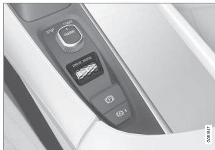
1. Appuyez sur la commande de mode de conduite **DRIVE MODE**.
