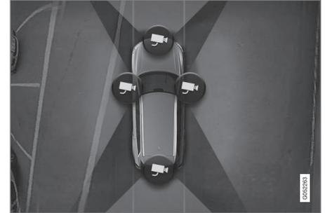
Emplacement des caméras d'aide au stationnement et zone couverte.
