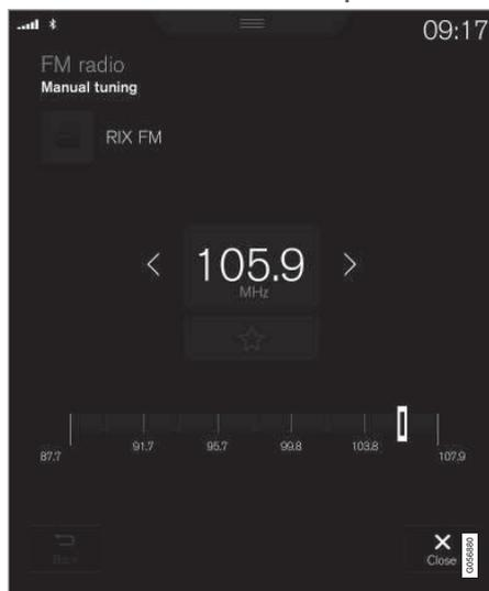
Lorsque vous passez à la recherche manuelle de stations, la radio ne changera plus automatiquement de fréquence si la réception se dégrade.
