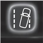
Si ce n'est pas le cas, un symbole et un message **Aide maintien ds voie Utiliser la direction** s'affichent sur l'écran du conducteur, invitant ce dernier à contrôler activement la direction de sa voiture.
