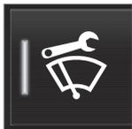
Appuyez sur le bouton **Posit. entretien essuie-glace**. Le témoin du bouton s'allume lorsque la position d'entretien est activée. À son activation, les essuie-glace montent et restent en position verticale.
