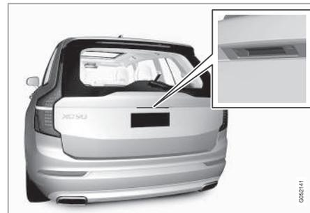
Bouton gainé de caoutchouc avec surface tactile.
