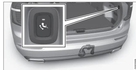
1. Ouvrez le hayon. Un bouton situé sur le côté droit à l'arrière dans le compartiment à bagages permet de sortir et de rentrer le crochet d'attelage. Un témoin sur le bouton doit s'allumer en orange pour permettre la sortie du crochet.
