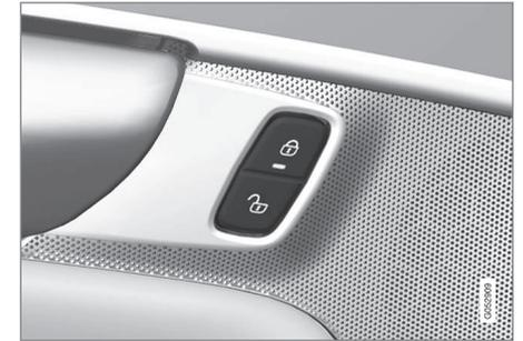
Bouton de verrouillage/déverrouillage de porte avant avec témoin
