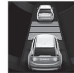
Ce n'est que lorsque le symbole de distance affiche deux véhicules que la distance temporelle avec le véhicule qui précède est ajustée par l'ACC.
