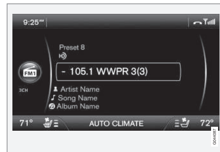
Exemple d'une station HD Radio avec sous-canaux
