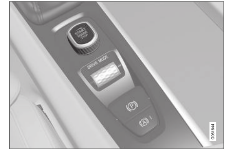
Pokrętko rozruchu na konsoli między fotelami.
