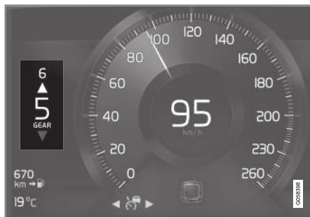
Fokozatváltás-jelző a 8-hüvelykes járművezetői kijelzőn.
