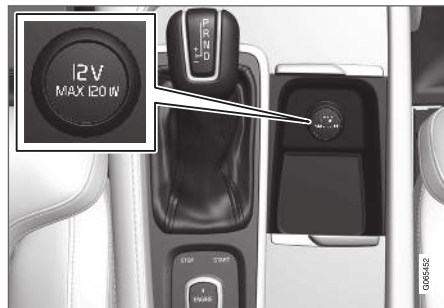
12 voltos elektromos aljzat az alagút-konzolban, első ülés.
