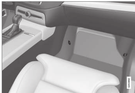
Rögzítőpontok elhelyezkedése az első ülésen.
