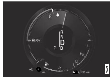
Mostrador do condutor em condução tanto com o motor eléctrico como com o motor de combustão.
