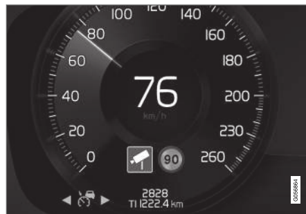
Informação de câmara de velocidade no mostrador do condutor.
