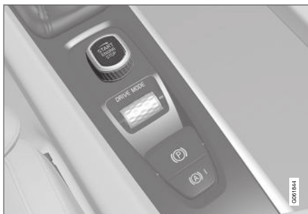
Disco de arranque na consola de túnel.
