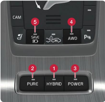
El automóvil cuenta con dos motores, uno eléctrico y otro de combustión interna diésel. Se pueden elegir diferentes modos de conducción. No se puede seleccionar un modo de conducción "equivocado". El automóvil regresará a modo HYBRID si no se cumplen ciertas condiciones. La lámpara del botón HYBRID se encenderá.
