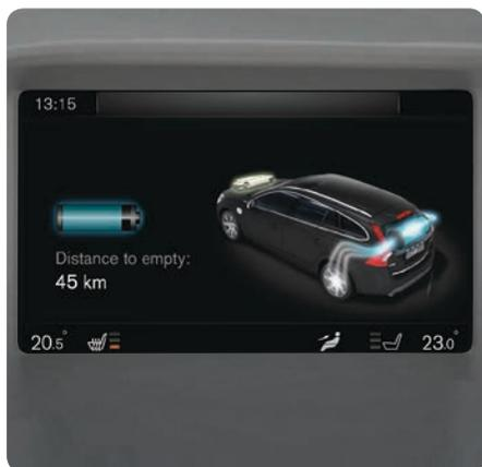
En **MY CAR** se gestiona buena parte de las funciones del automóvil como la programación del reloj y el ajuste de los retrovisores y los cierres. Las estadísticas de viaje y el flujo de la potencia se muestran también gráficamente. En la vista normal de **MY CAR** pulse **OK/MENU** y seleccione **Híbrido**:
