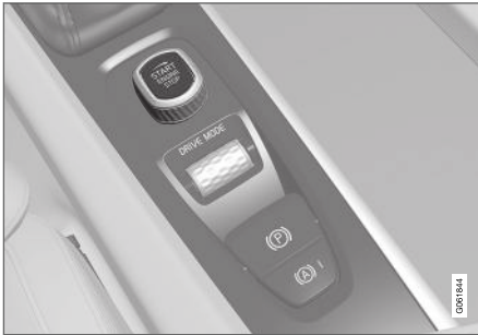
Startvredet i tunnelkonsolen.
