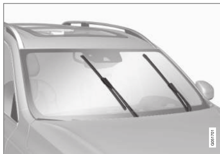
Torkarblad i serviceläge.
