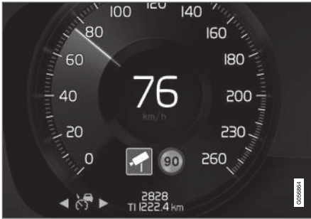
Nopeuskameratiedot kuljettajan näytössä 112 .
