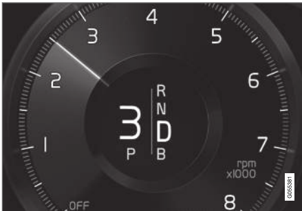
Kuljettajan näyttö vaihdettaessa ohjauspyörävalitsimilla.
