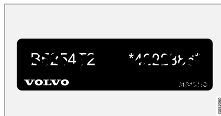
4 Tarra, jossa ovat moottorikoodi ja moottorin valmistusnumero.
