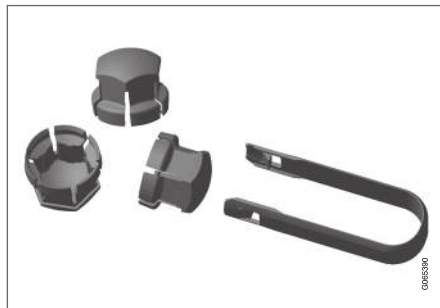
Työkalu pyöränruuvien muovihattujen poistamista varten.
