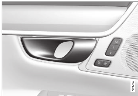
Avauskahva vaihtoehtoista sivuoven lukituksen avaamista varten 14 .
