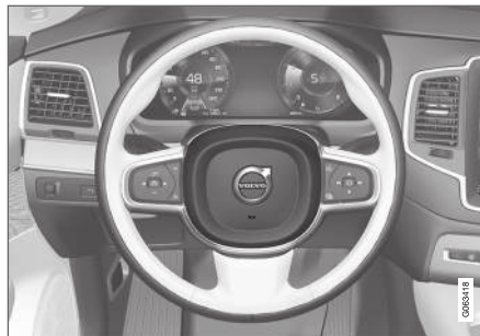
Äänitorven kytkin on sijoitettu ohjauspyörän keskiöön.
