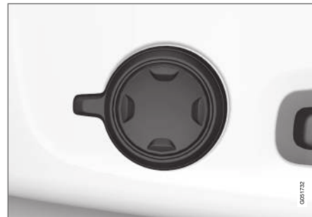
Monitoimisäädin, sijoitettu istuimen istumaosan sivulle.
