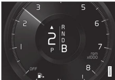
Vaihtamisosoitin kuljettajan näytössä 3 .
