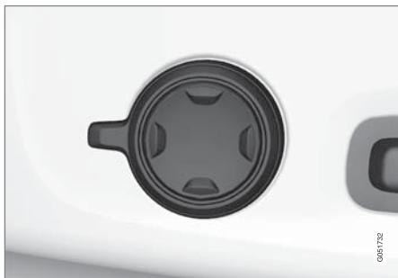
シート座面の横にあるマルチファンクションコントロール
