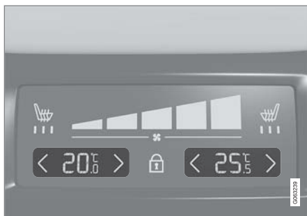
トンネルコンソール後部にあるクライメートパネルの温度調節
