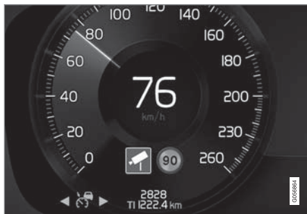
ドライバーディスプレイのスピード違反取り締まりカメラ情報 106
