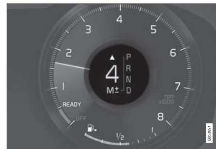
12 インチドライバーディスプレイ*のギヤシフトインジケーター
