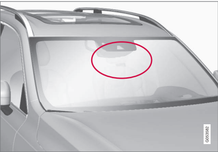
Der markierte Bereich muss regelmäßig gereinigt werden und frei von Aufklebern, Gegenständen, Sonnenschutzfolie usw. sein.
