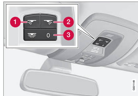
Az első olvasólámpák és az utastér-világítás kezelőszervei a tetőkonzolon.
