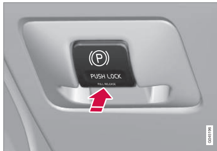
A rögzítőfék kezelőszerve - behúzás.
