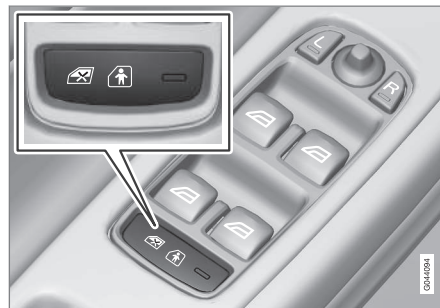
Pannello di comando nella portiera del conducente.
