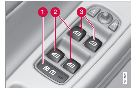
Painel de comando da porta do condutor.
