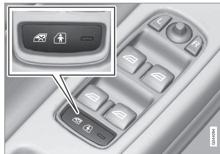
Panel de comando da porta do condutor.
