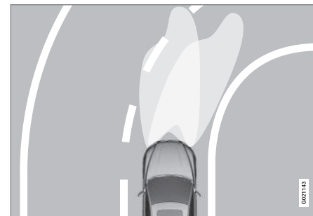
Modèle de phare avec la fonction Active Bending Light (phares directionnels) désactivée (à gauche) et activée (à droite)
