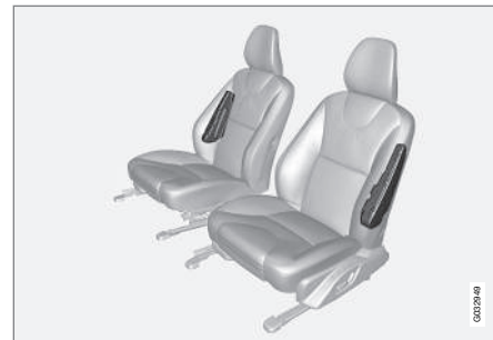
Emplacement des coussins gonflables contre les impacts latéraux (SIPS) (sièges avant seulement)
