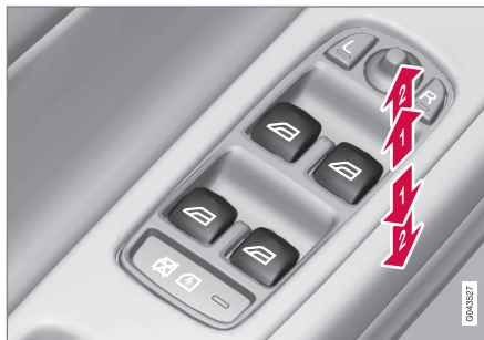
Fonctionnement des vitres électriques
