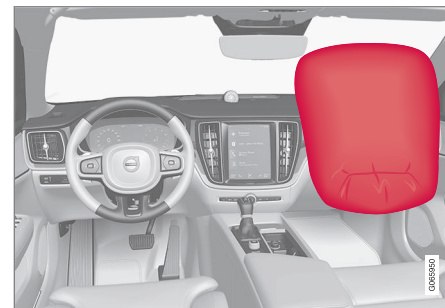
Czołowa poduszka powietrzna pasażera przedniego fotela.
