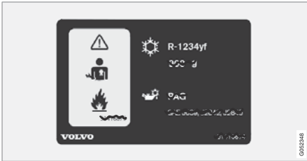
2 냉매 R1234yf를 사용하는 차량의 A/C 시스템 스티커.
