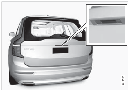
テールゲートのラバー加工されたプレッシャープレート(ロック解除のみに使用)
