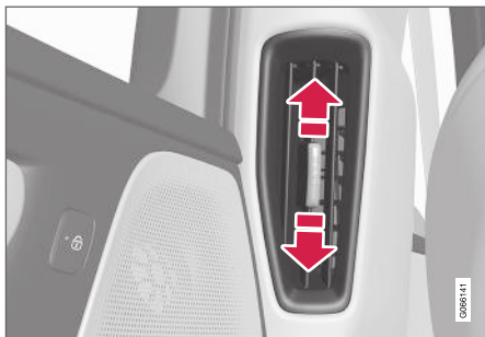
Palanca de la tobera de ventilación 2 .
