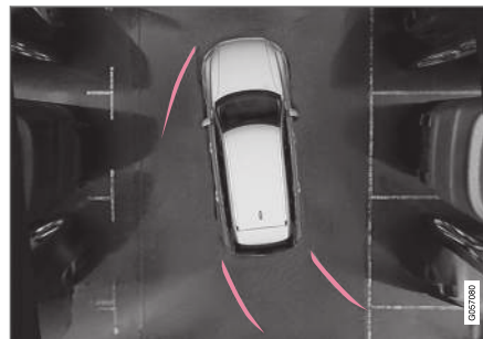
Vista de 360° con líneas auxiliares 132 .
