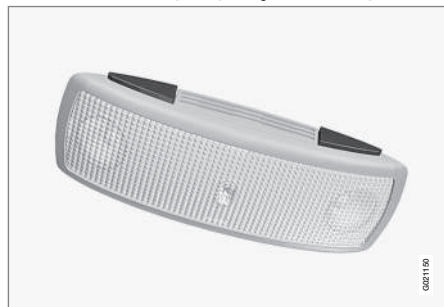
Oświetlenie w tylnej części kabiny.
