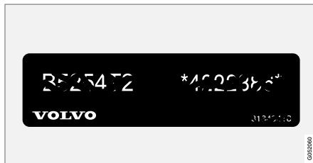
4 Tarra, jossa ovat moottorikoodi ja moottorin valmistusnumero.
