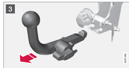
3 บิดปุ่มล็อกลงสุดจนหยุด จับไว้ในตำแหน่งนี้ในขณะที่ดึงส่วนลูกปืนข้อต่อไปข้างหลังและดึงขึ้น
